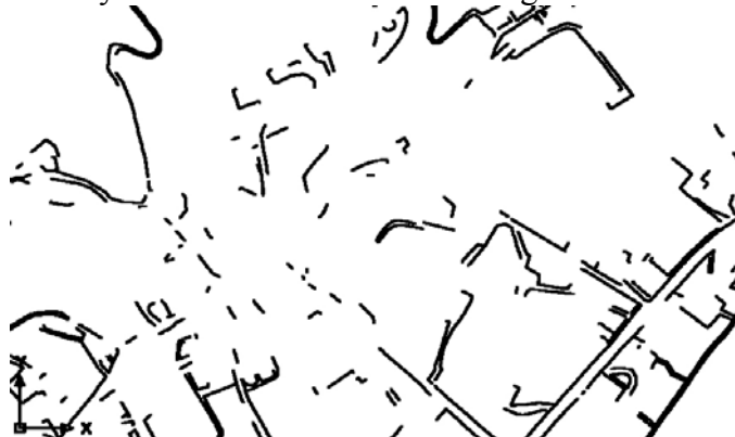
Layer della viabilità in un aereofotogrammetrico
