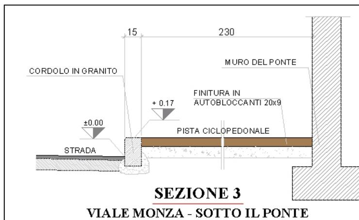
In particolare, la pista ciclabile risulta realizzata con finitura in massetti autobloccanti con una dimensione massima di 3,00 metri circa (sezioni 2, 4 e 5) e minima di 2,30 metri (sezione 3 sotto il ponte della Vallassina).
